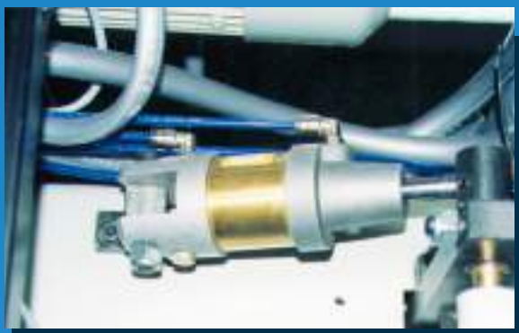
Bloccaggio pneumatico carrello trave Pneumatic locking of the beam-carriage
