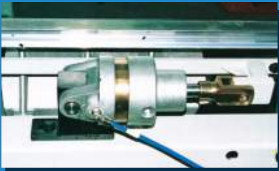
Sollevamento pneumatico dei rulli Pneumatic lift of the rollers
