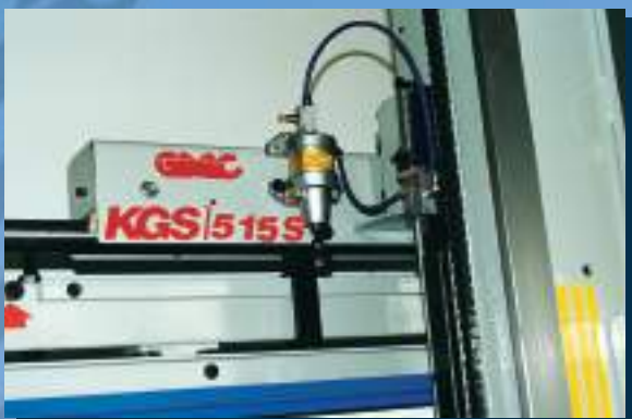
Telaio mobile pneumatico Pneumatic moving frame
