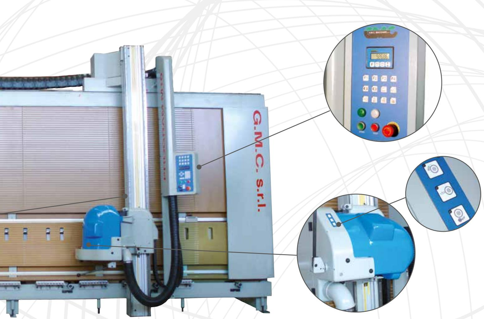
La version standard de la machine offre le basculement du groupe-lame, la plongée de la lame et le blocage des axes; pneumatiques.
