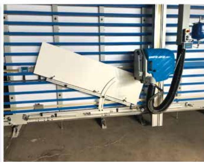
Les dispositifs “Angol II” et “Angol III” sont utilisés pour effectuer des coupes angulaires verticalement et horizontalement.
