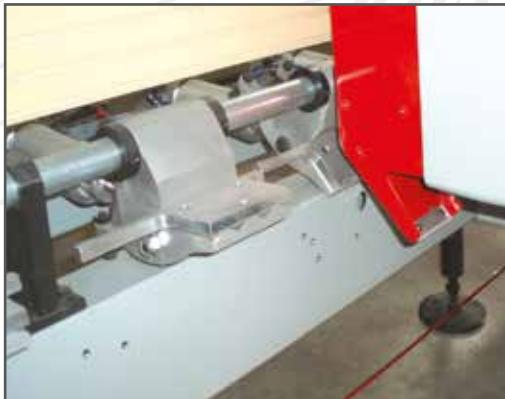
Supporti di alluminio mobili ed a scomparsa, azionati dal programmatore. Permettono di eseguire tagli verticali in ogni punto. Vengono montati in abbinamento al gruppo incisore sul mod. KGS/GMC 180 CN
