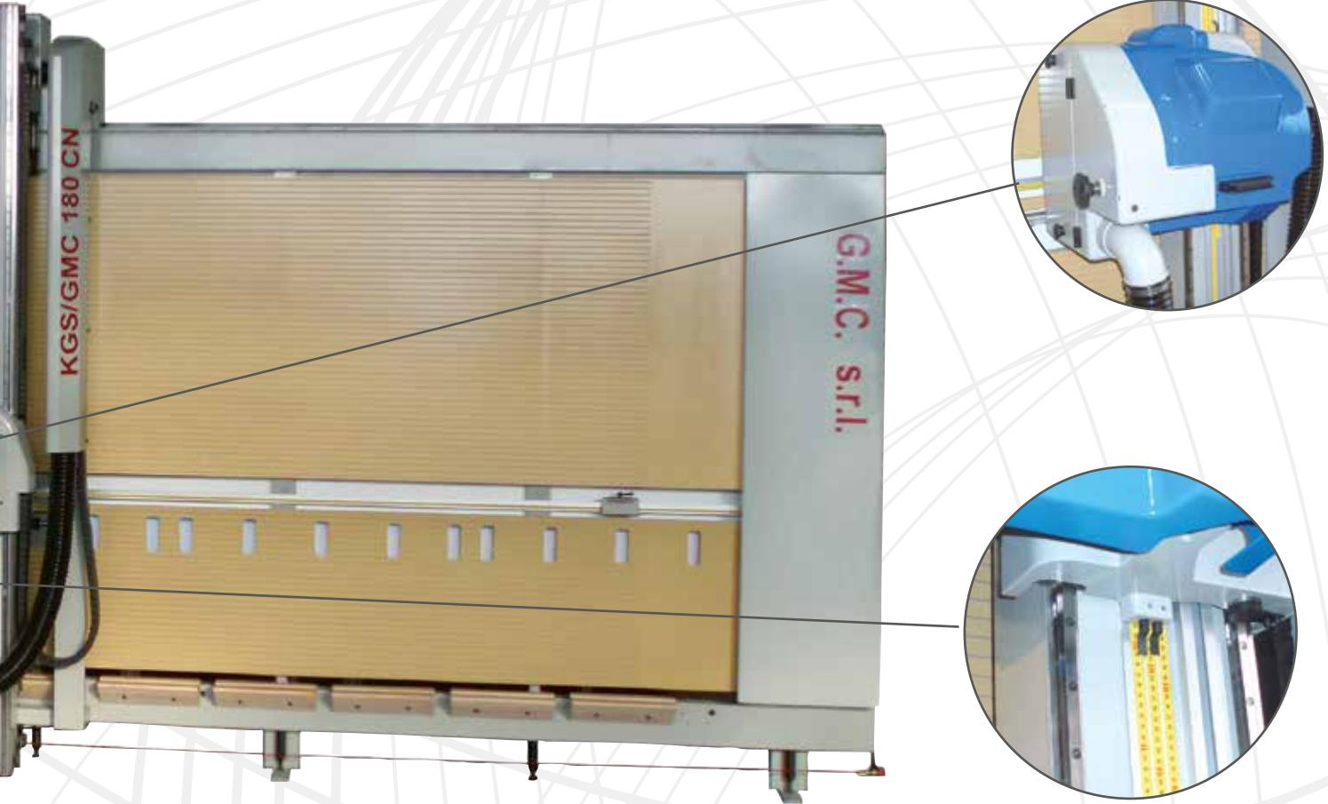
La version standard de la machine comprend le basculement du groupe-scie, la plongée de la lame et le blocage des axes; totalement automatiques.
