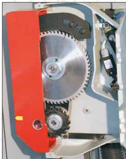
Il dispositivo “SCU” viene azionato tramite un selettore manuale, posto nella parte frontale inferiore del carter. Tramite il selettore si sceglie l'utensile che si vuole utilizzare: lama per tagliare, fresa per fresare (nel mod. KGS/GMC 180 CN, il selettore è azionato dal programmatore). L'inserimento della fresa per fresare e la sua esclusione avviene tramite un cilindro pneumatico.
